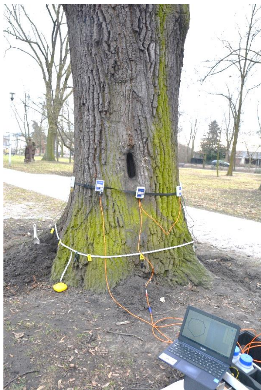
Badanie tomografem sonicznym
